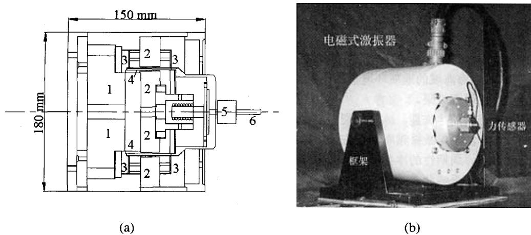
图 2 (a)电磁式激振器纵剖面图 (b)电磁式激振器实物图
