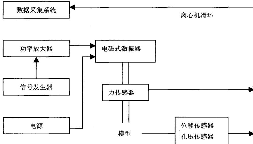
图 3 激振器加载控制示意图
