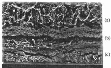
图4 4# 试样的断口微观照片。
