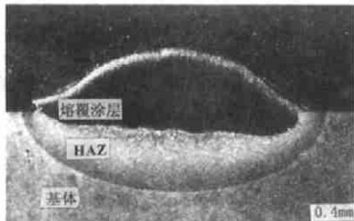
图 1 熔覆层宏观形貌
