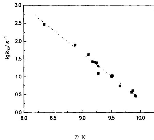
图 1 1,2-二氯乙烷裂解的 Arrhenius 关系图
