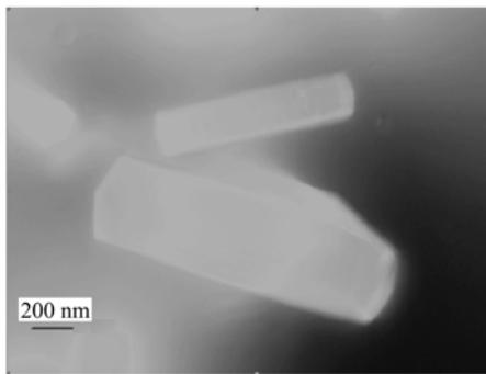
图 3 荧光显微镜下拍摄的 FITC-溶菌酶晶体
