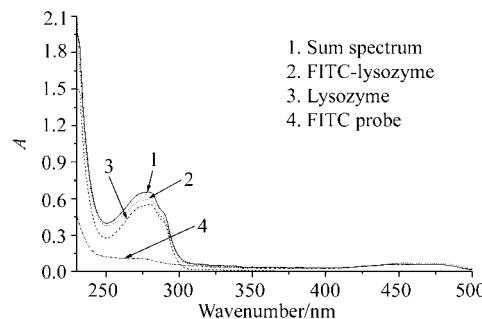
图 1 溶菌酶、FITC 和 FITC-溶菌酶吸收谱图
