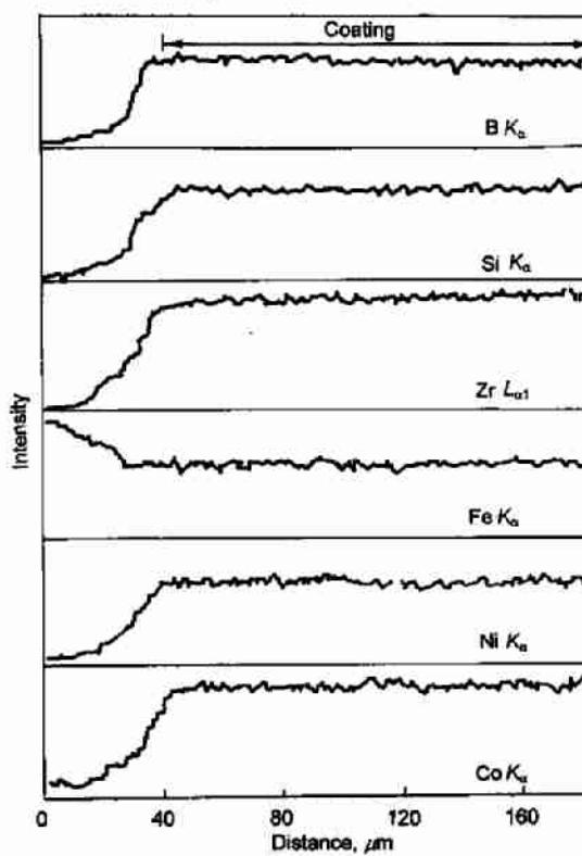
图1 Fe<sub>57</sub>Co<sub>8</sub>Ni<sub>8</sub>Zr<sub>10</sub>Si<sub>4</sub>B<sub>13</sub> 涂层合金元素沿深度方向的EDS分析
