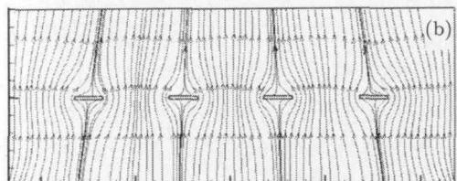
(b) 此时三相接触线上出现短链, 此处短链被模拟为平板。平板长度为  $30\mu\text{m}$ (模拟短链), 厚度为  $3\mu\text{m}$ (模拟短链厚度), 平板之间的距离为  $100\mu\text{m}$ (模拟短链之间距离)
