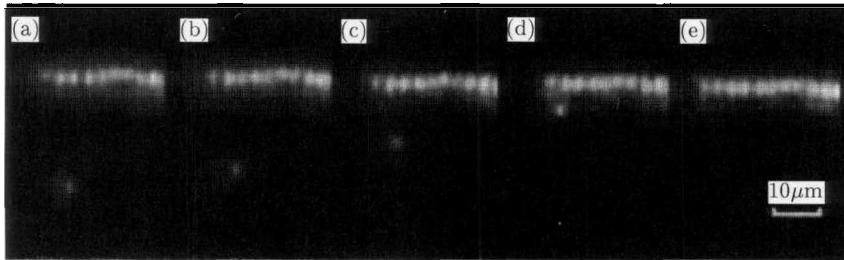
图 6 颗粒运动至长链的端部 (图中长链长度为  $29\mu\text{m}$ , 颗粒垂直运动速度为  $3.30\mu\text{m}/\text{s}$ , 水平运动速度为  $1.38\mu\text{m}/\text{s}$ )
