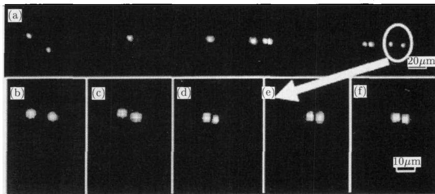
图 2 三相接触线上毛细力作用下的颗粒聚集现象
