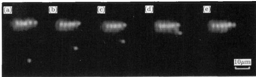
图 3 颗粒向短链端部移动 (图中短链长度为  $15\mu\text{m}$ , 颗粒垂直运动速度为  $3.01\mu\text{m}/\text{s}$ , 水平运动速度为  $0.75\mu\text{m}/\text{s}$ )
