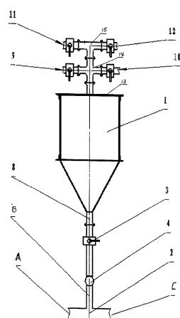
1. 一种具有引射功能的加料的装置，包括一储液罐（1）、输运管（8）、阀门（3）；其特征在于，还包括引射器（2）、单向阀（4）、上盖（13）、四通（14）、三通（15）；所述的储液罐（1）由一金属圆筒和安装在金属圆筒下端口的金属漏斗组成，一上盖（13）密封固定在储液罐（1）的上端口，上盖（13）通过发蓝固定连通一根四通（14），四通（14）的上端口安装一三通（15），四通（14）的左右两端口分别为液体入口（9）和气体入口（10），三通（15）的一个端口为固体入口（11），另一个端口安装压力表（12）；储液罐（1）的漏斗下口固定一根输运管（8），该输运管（8）上设置有阀门（3）和单向阀（4），单向阀（4）的另一端口连接所述的引射器（2），所述的引射器引入口（A）和引射器出口（C）水平放置，引射器固相引入口（B）垂直向上，与要接的管线在同一水平面上安装。
