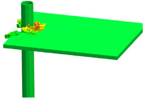
图2 海洋平台管桩结构与海冰作用计算
