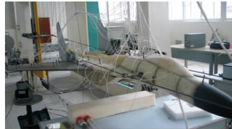
图 4 模型地面 GVT 试验 Fig. 4 GVT for the flutter model
