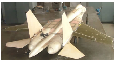
图 2 全机缩比弹性相似颤振模型的制作 Fig. 2 Manufacture of the flutter model
