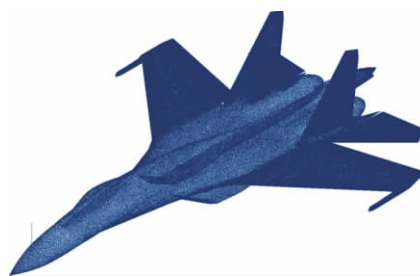
(a) 风洞模型的全机表面网格
