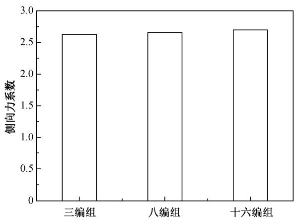
图 13 不同编组列车头车侧向力系数比较
