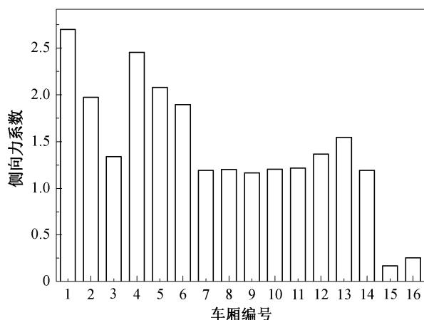
图 8 不同车厢的侧向力系数比较
