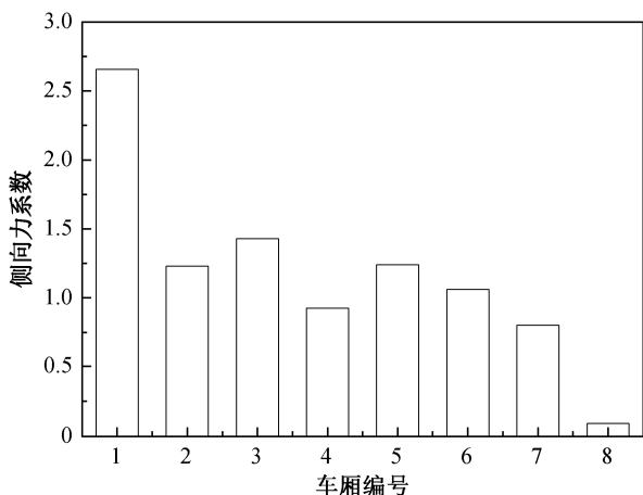
图 11 八编组列车不同车厢的侧向力系数比较
