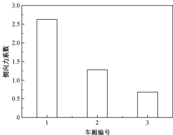
图 12 三编组列车不同车厢的侧向力系数比较
