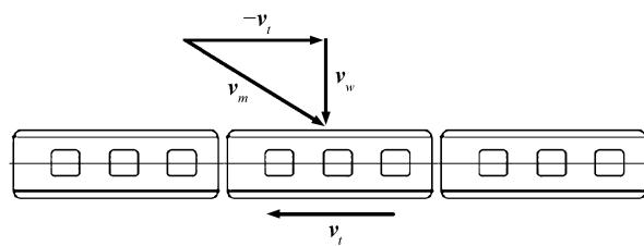
图 3 横风作用的速度三角形
