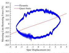
FIGURE 16. COMPARISON RESTORE FORCES BETWEEN THE DYNAMIC AND STATIC MOORING SYSTEM
