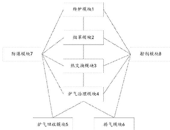
1. 一种转炉炉气后处理及余热回收装置，其特征在于，所述装置包括：转炉模块、烟罩模块、热交换模块、炉气治理模块、炉气回收模块、排气模块、防爆模块、控制模块；
