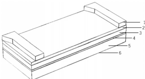
1. 一种激光无线充电接收端，其特征在于，包括石墨烯封装的单晶硅光电池，所述石墨烯封装的单晶硅光电池设置为由电极和电池层组成的光电池，
