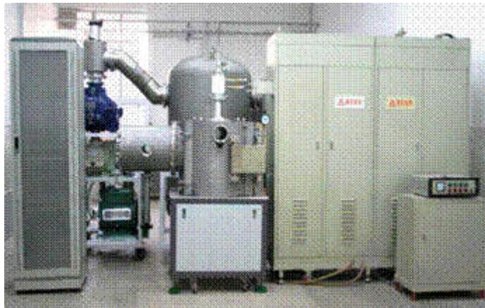
图4 2000年后新建的小型电弧/高频等离子体风洞
