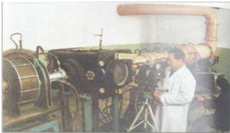
图2 原十一室三组的兆瓦级电弧风洞
