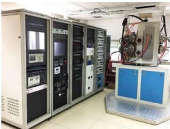
图5 力学所用于制备 $(\text{AlCrTiVZr})\text{N}$ 薄膜的PVD设备照片（来源：作者拍摄）
