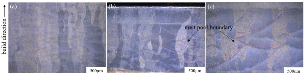
图 7 沉积态 Ti6Al4V 在不同  $E_0^*$  下的柱状晶形貌。 (a)  $E_0^* = 2.18$ ; (b)  $E_0^* = 2.34$ ; (c)  $E_0^* = 3.93$
