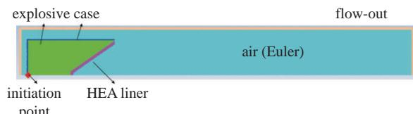
(b) 高熵合金射流成型 1/2 有限元模型
