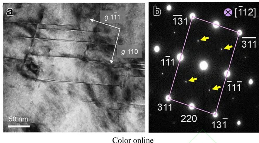
图 6 B 摻杂  $\text{Fe}_{40}\text{Mn}_{40}\text{Co}_{10}\text{Cr}_{10}$  高熵合金低温变形组织中的短程有序结构<sup>[93]</sup>
