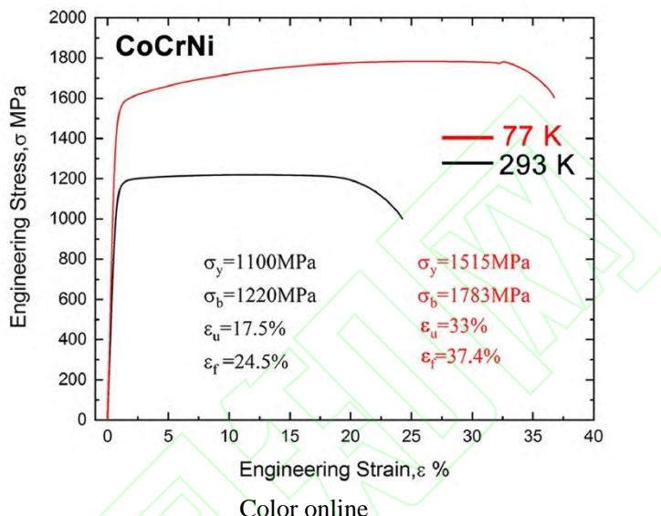
图 13 热拉拔 CoCrNi 丝材的室温及低温力学性能<sup>[49]</sup>
