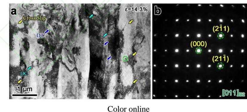
图 14 AlCoCrFeNi<sub>2.1</sub> 共晶高熵合金丝材低温拉伸时的组织特征<sup>[102]</sup>
