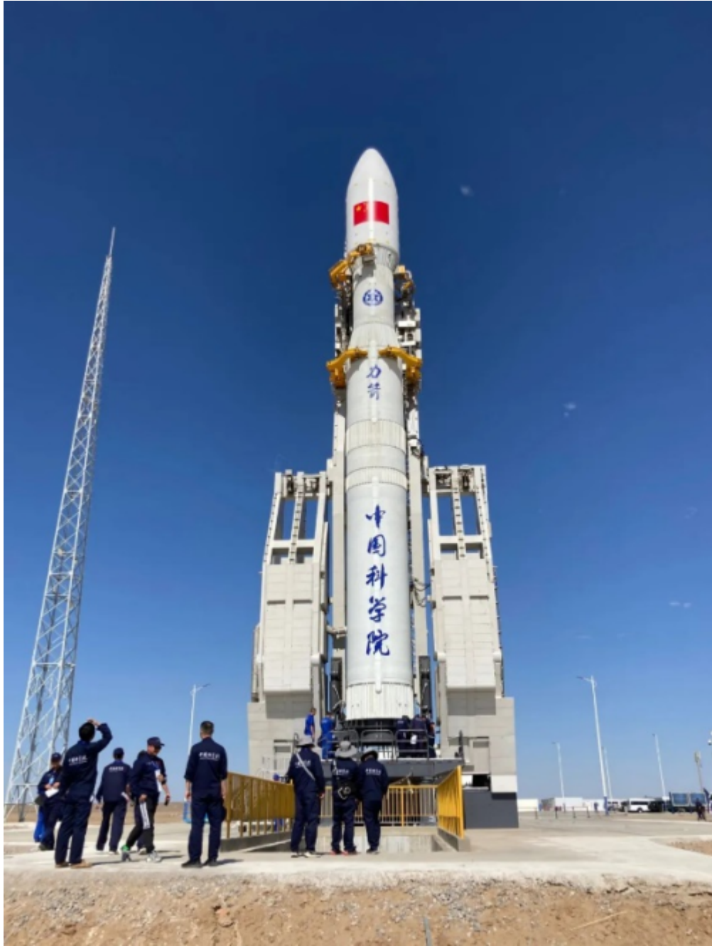
图5 采用无依托发射模式的“力箭一号”在起飞前（图片来源：力学研究所）
